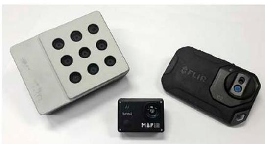
**Foto 2** Tre esempi di sensore: multispettrale Maia, con un canale di acquisizione fotografico (RGB) e 8 canali su 89 diverse lunghezze d'onda; al **centro** la fotocamera Mapir per acquisizioni infrarosse (NIR); a **destra** una camera Flir che opera sul lontano infrarosso per la stima delle temperature
