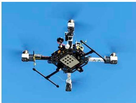
**Foto 3** Un drone equipaggiato con sonda multispettrale Maia
